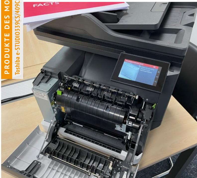
**DAS IST SICHER:** Obwohl es bei den Tests keinen Papierstau gab, wäre ein solcher durch die „offene“ Bauweise vom Anwender sehr leicht zu beheben.
